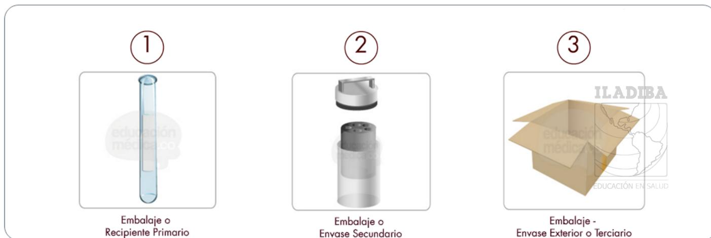
Figura 12. Sistema de Triple Embalaje.
