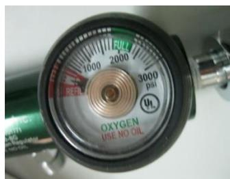
El manómetro nos indica la cantidad de gas que hay en el cilindro. Generalmente se recibe la grande con 2.000psi y la pequeña con 1.000psi.
