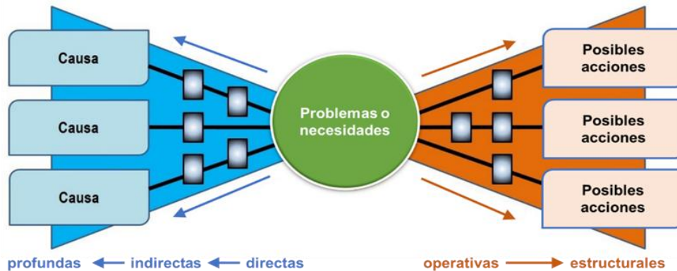
Figura 4. Representación gráfica de la adaptación del método Bowtie para análisis de problemas
