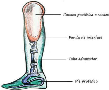
Figura 11. Componentes de una prótesis para amputación transtibial
