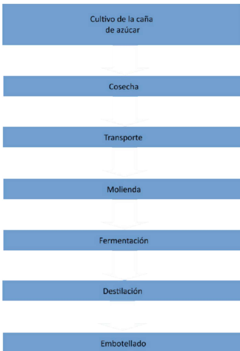
Figura 1. Diagrama esquemático de los procesos empleados para la elaboración del viche/biche
